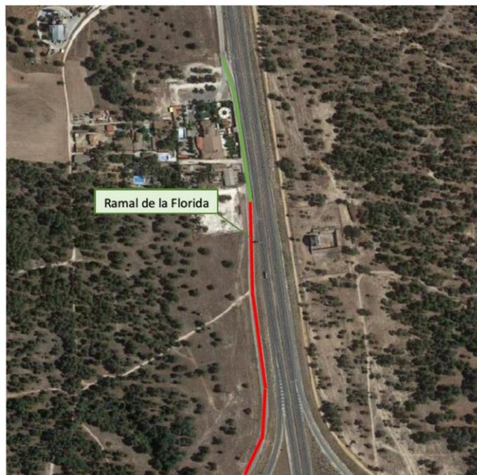
Imagen nº3. Ubicación de los tramos con los dos tipos de mezcla bituminosa. En este Ramal en verde la ubicación de la mezcla semicaliente y en rojo, hasta el final del Ramal, la caliente.
