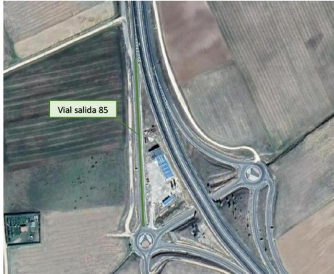
Imagen nº2. Ubicación de los tramos con los dos tipos de mezcla bituminosa. En este vial 85 toda la mezcla bituminosa colocada fue semicaliente.
